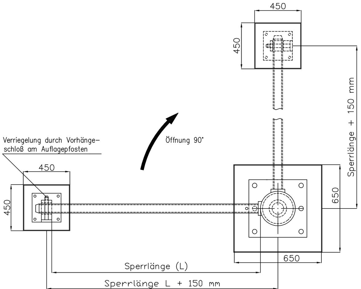
Maximale Sperrlänge  $L = 9000$  mm
